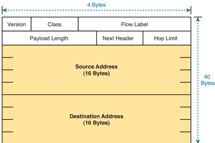
**Figure 25-3** IPv6 Header
